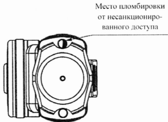
Рисунок 3.1 – Схема пломбировки от несанкционированного доступа (вид снизу)
