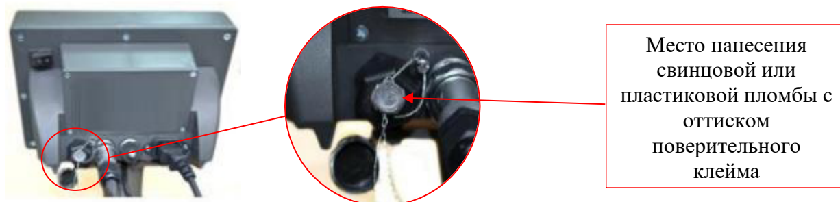
Рисунок 6 – Схема пломбировки весов с применением весоизмерительных приборов ТИТАН от несанкционированного доступа и место нанесения знака поверки
