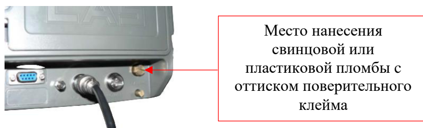
Рисунок 7 – Схема пломбировки весов с применением весоизмерительных приборов СИ-200А от несанкционированного доступа и место нанесения знака поверки
