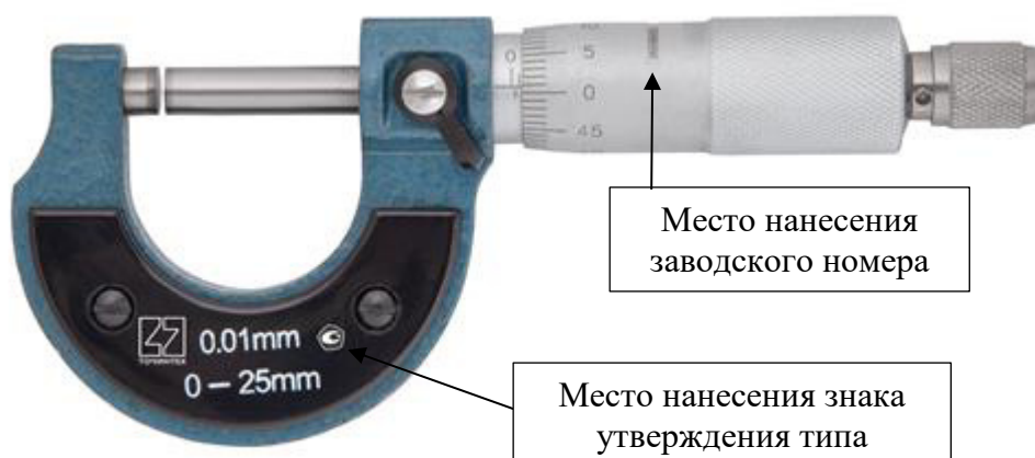
Рисунок 4 – Общий вид микрометров типа МК с отсчетом показаний по шкалам стебля и барабана с указанием мест нанесений заводского номера и знака утверждения типа
