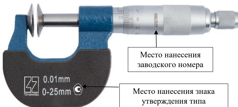
Рисунок 18 – Общий вид микрометров типа МЗ с отсчетом показаний по шкалам стебля и барабана с указанием мест нанесения заводского номера и знака утверждения типа
