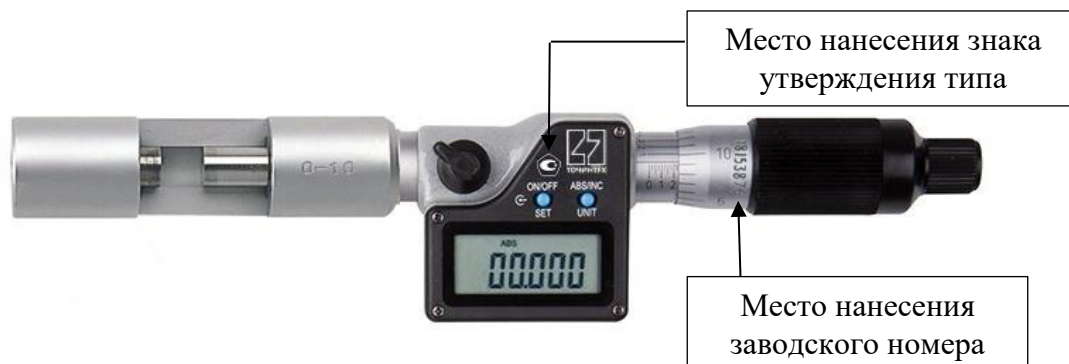
Рисунок 23 – Общий вид микрометров типа МП с отсчетом показаний по электронному цифровому устройству с указанием мест нанесений заводского номера и знака утверждения типа
