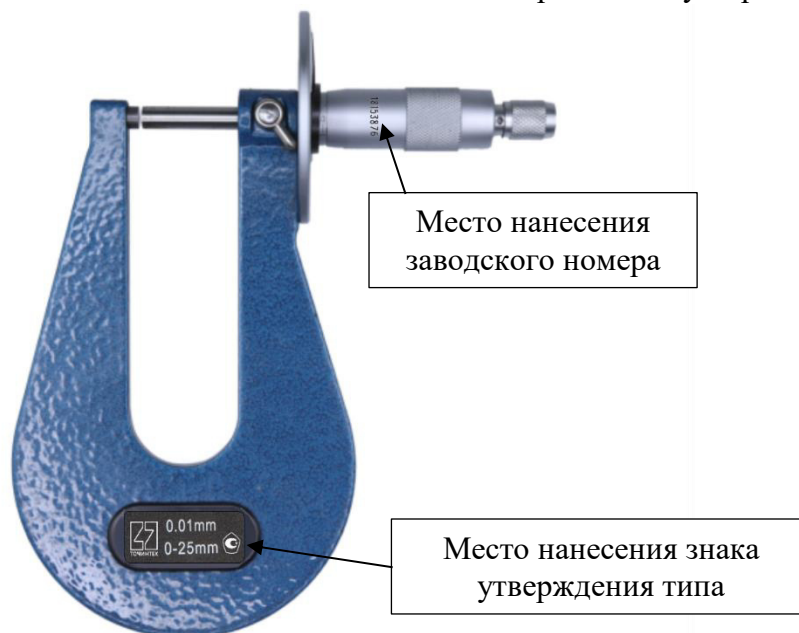
Рисунок 16 – Общий вид микрометров типа МЛ с указанием мест нанесений заводского номера и знака утверждения типа
