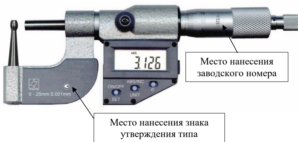
Рисунок 15 – Общий вид микрометров типа МТ с отсчетом показаний по электронному цифровому устройству с указанием мест нанесений заводского номера и знака утверждения типа
