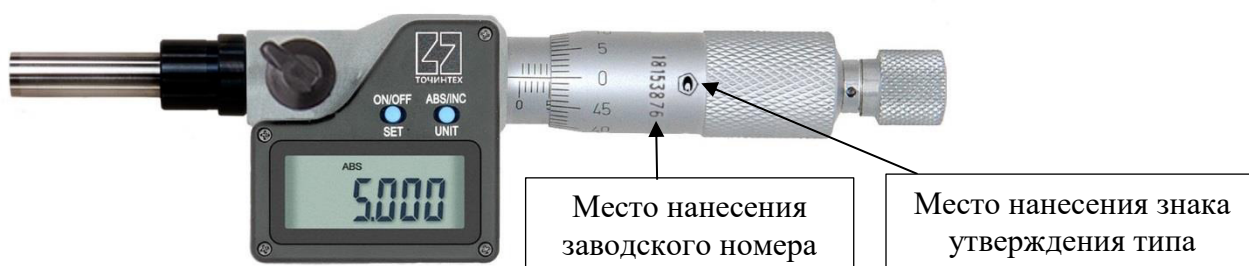
Рисунок 21 – Общий вид микрометров типа МГ с отсчетом показаний по электронному цифровому устройству с указанием мест нанесений заводского номера и знака утверждения типа
