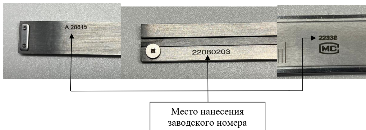
Рисунок 8 – Места нанесения заводских номеров
