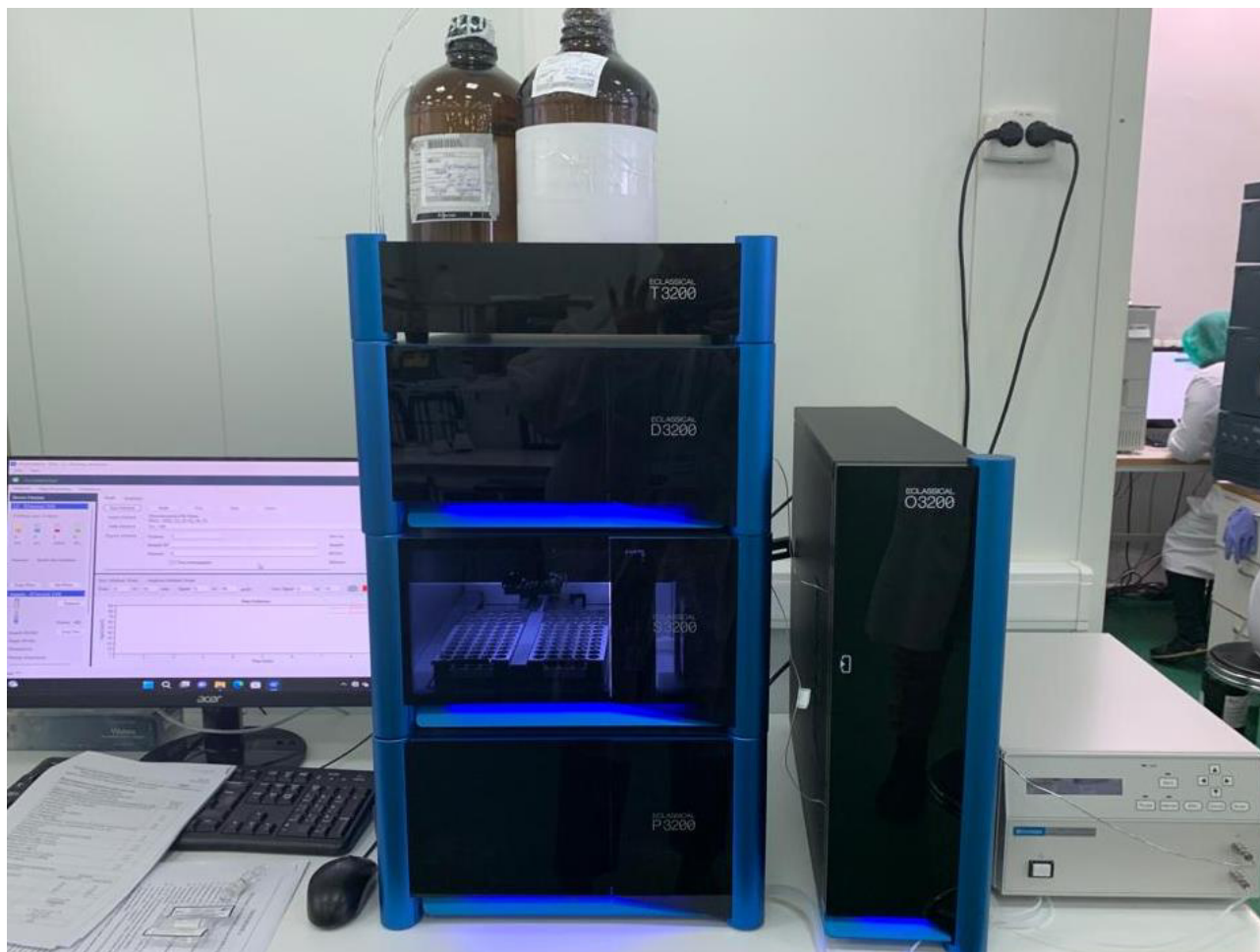
Рисунок 2- Внешний вид хроматографов жидкостных УВЭЖХ Elite
