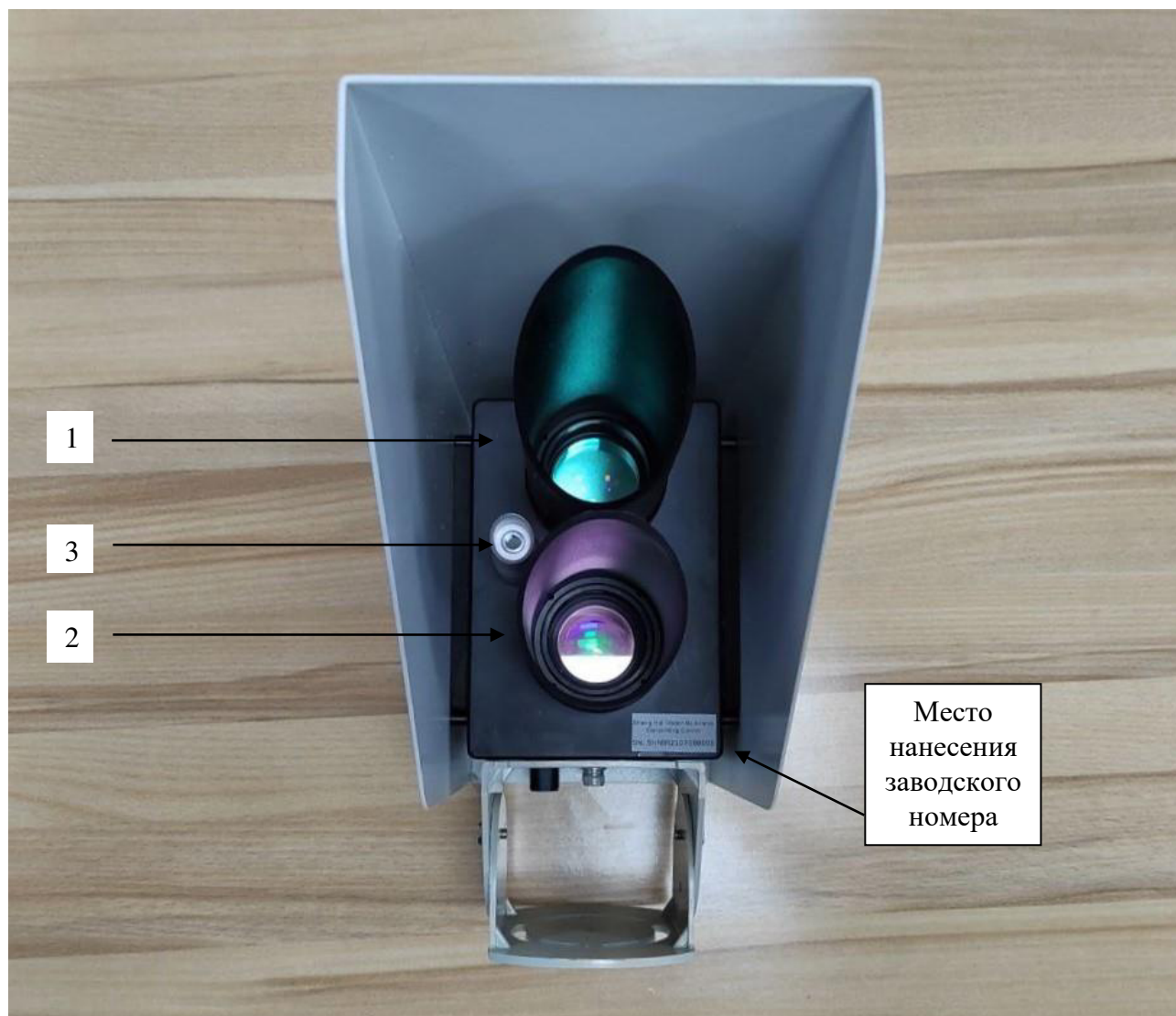
Рисунок 1 – Общий вид датчиков NIR51 1 – излучатель, 2 – приемник, 3 - пирометр
