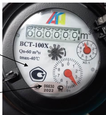
Рисунок 3 – Место нанесения знака утверждения типа и заводского номера
