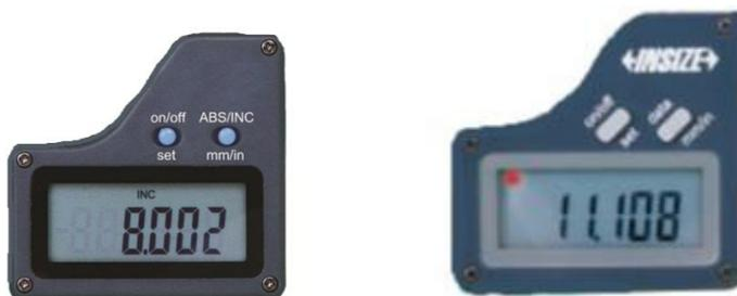
Рисунок 10 – Общий вид цифрового отсчетного устройства нутромеров модели 3520
