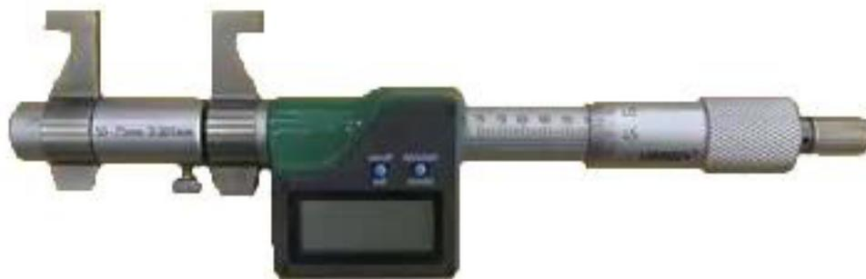
Рисунок 7 – Общий вид нутромеров модели 3520
