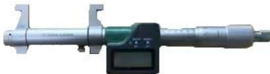
Рисунок 8 – Общий вид нутромеров модели 3520
