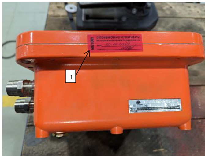
Рисунок 4 – Место пломбирования контроллера (1) с исполнением во взрывозащищенном корпусе
