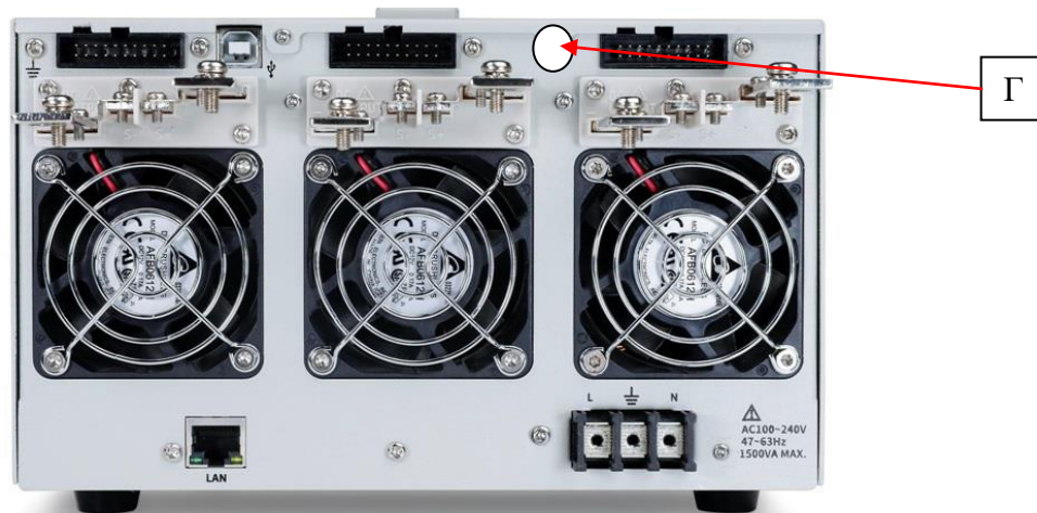
Рисунок 2 – Схема пломбировки от несанкционированного доступа (Г)
