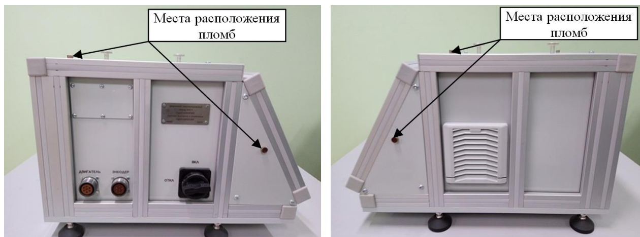
Рисунок 2 - Схема пломбирования станда от несанкционированного доступа
