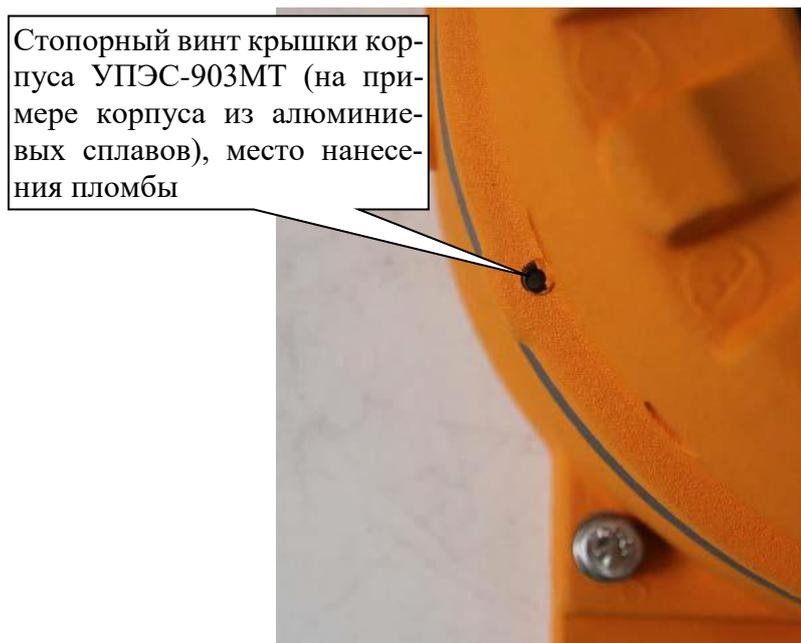
Рисунок 4 - Схема пломбировки газоанализаторов от несанкционированного доступа
