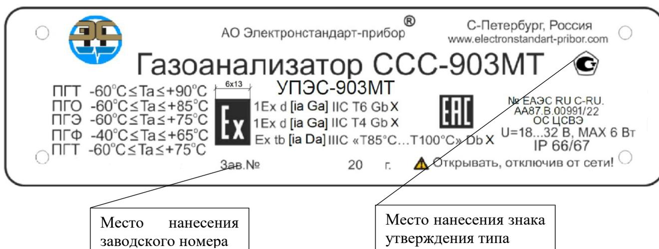
Рисунок 5 – Табличка, расположенная на корпусе газоанализатора
