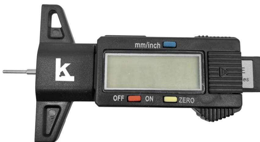
Рисунок 10 – Общий вид штангенглубиномеров модели ИВПЦ
