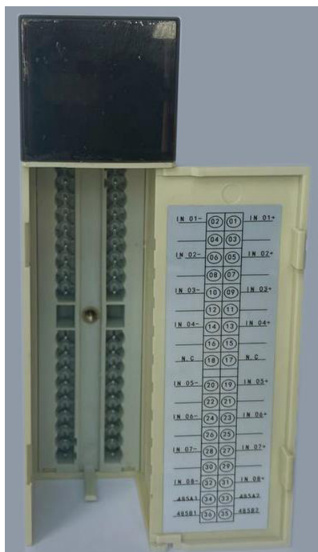
Рисунок 2 – Общий вид измерительного модуля программируемых логических контроллеров серии СК-4000 с указанием места нанесения знака утверждения типа и заводского номера
