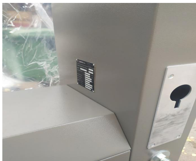
Рисунок 5 – Общий вид маркировочной таблички и места ее крепления на корпусе колонки
