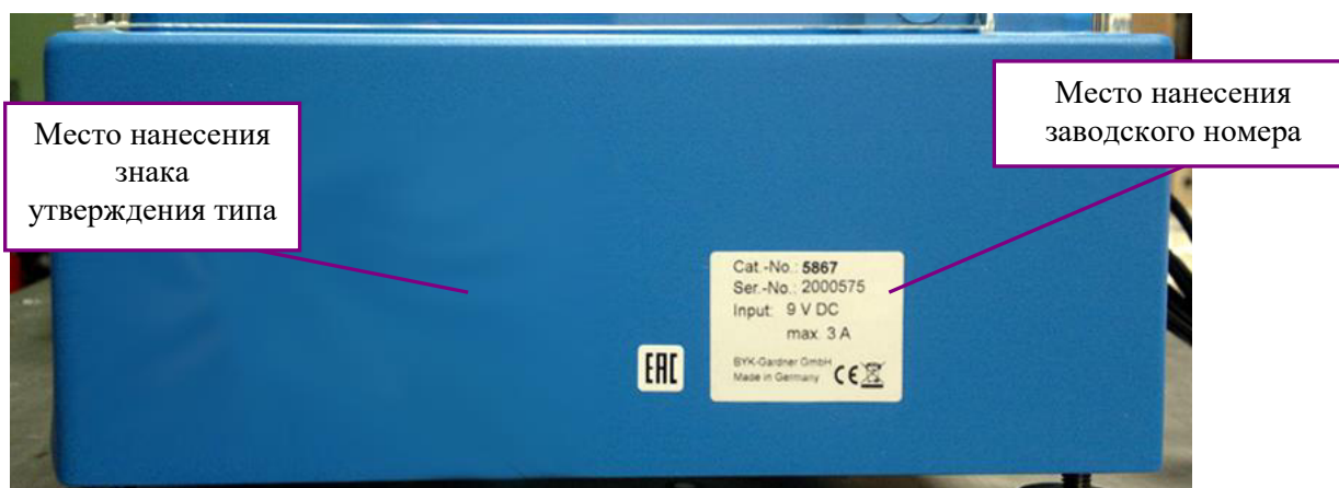
Рисунок 3 – Маркировка твердомеров с указанием мест нанесения знака утверждения типа и заводского номера
