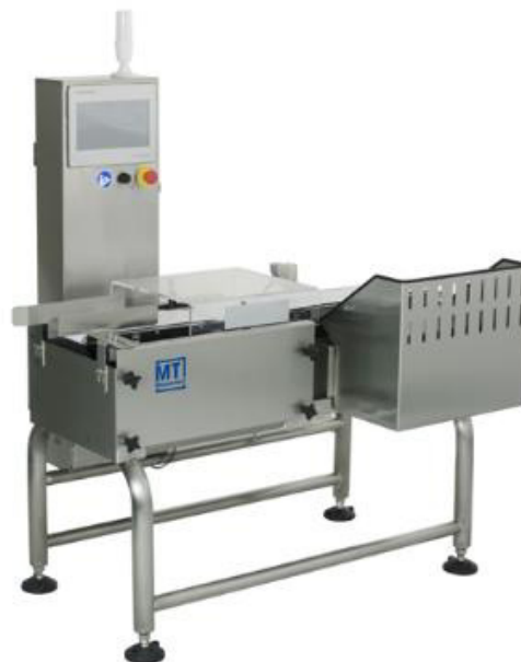
Рисунок 2 - Внешний вид АБУ для линий высокой производительности
