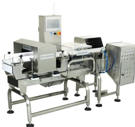
Рисунок 4 - Внешний вид АБУ со встроенным металлодетектором и устройством отбраковки
