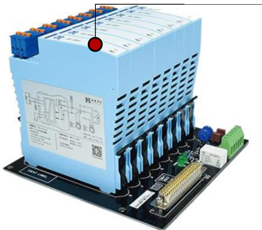
Рисунок 1 – Общий вид преобразователей исполнения «Н» с одним блоком вставных клемм, смонтированные на панель
