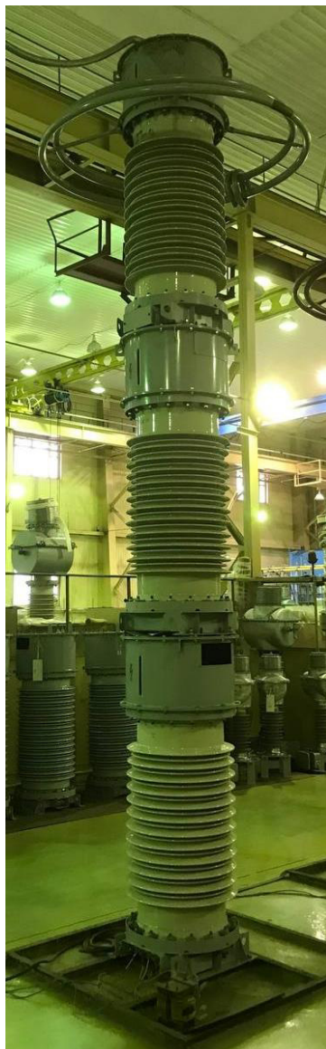
Рисунок 1 – Общий вид трансформатора напряжения ОМОН-330-500
