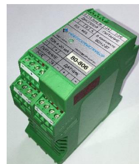
Рисунок 2б – Блок обработки в исполнении без клавиатуры и индикатора (БО)
