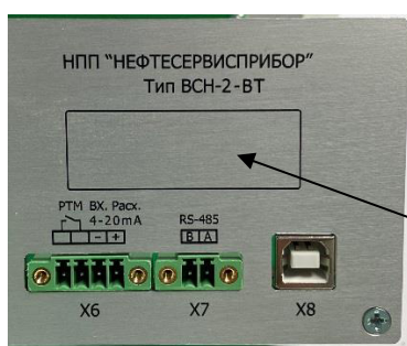
Рисунок 5а – Место нанесения знака утверждения типа и заводского номера на блок обработки в исполнении БОКИ
