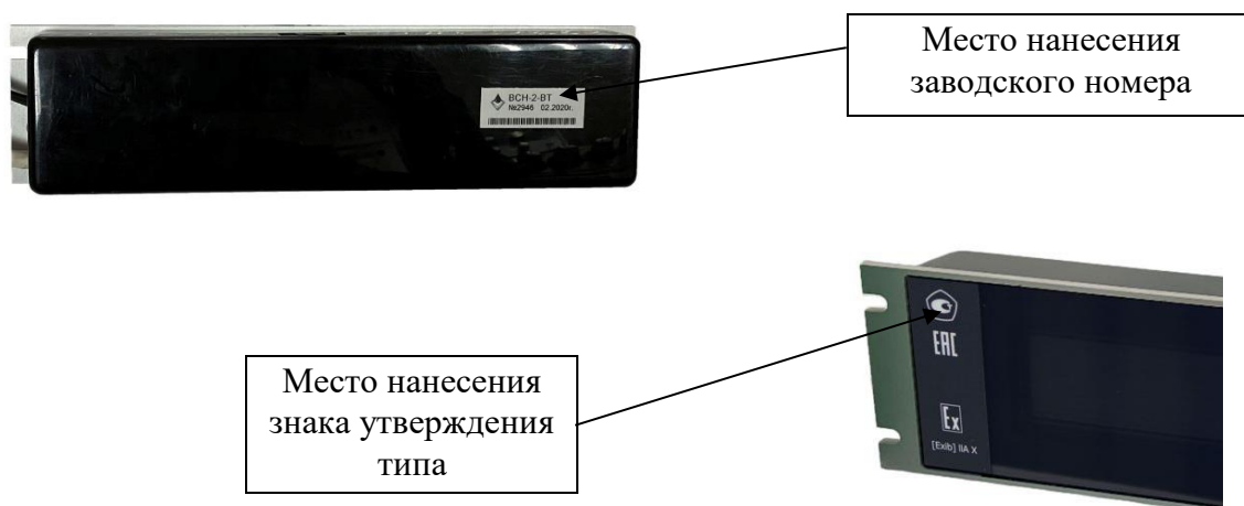
Рисунок 5г – Место нанесения заводского номера и знака утверждения типа на клавиатурно-индикаторный модуль
