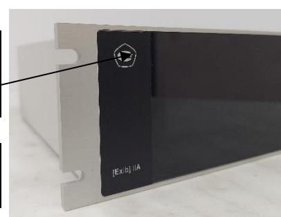
Рисунок 5а – Место нанесения знака утверждения типа и заводского номера на блок обработки в исполнении БОКИ
