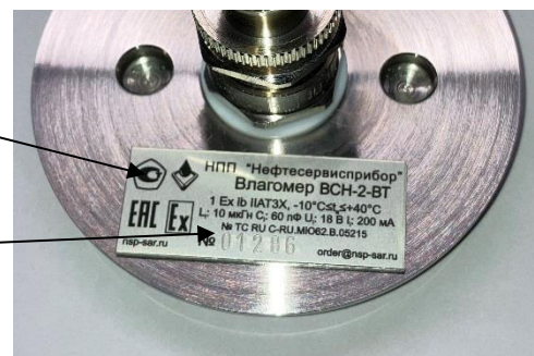
Рисунок 4в – Место нанесения знака утверждения типа и заводского номера на ПИП полнопоточного (погружного) исполнения
