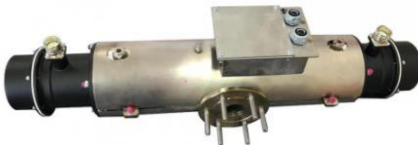
Рисунок 6 – Общий вид анализатора паров воды ГОС-18
