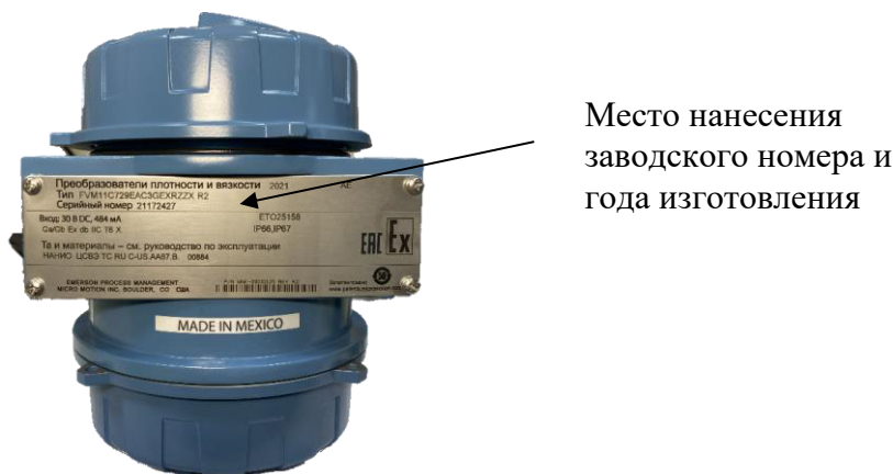
Рисунок 2 – Маркировка FVM Master
