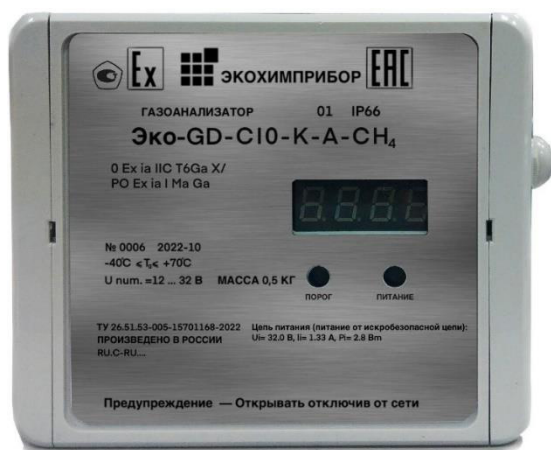
Рисунок 9 – Общий вид газоанализаторов Эко-ГД в искробезопасном исполнении, в пластиковом корпусе. Возможность применения во взрывоопасной зоне Класса 0. Исполнение в корпусе «К»
