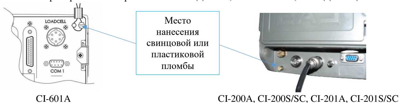
Рисунок 7 – Схема пломбировки от несанкционированного доступа весов с применением приборов весоизмерительных МИ ВДА/12Я, МИ ВЖА/12Я, МИ ВДА/12ЦС
