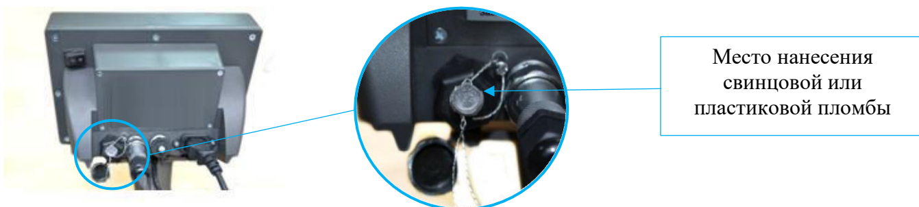
Рисунок 5 – Схема пломбировки от несанкционированного доступа весов с применением приборов весоизмерительных ТИТАН
