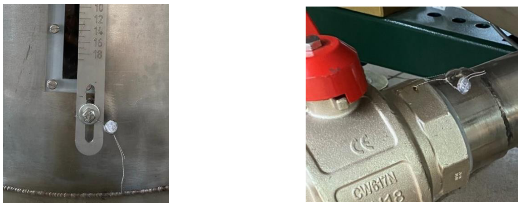
Рисунок 2 – Схемы пломбирования от несанкционированного доступа, обозначение мест нанесения знака поверки на регулируемые шкалы (при наличии) и сливные краны мерников установок поверочных УПМ
