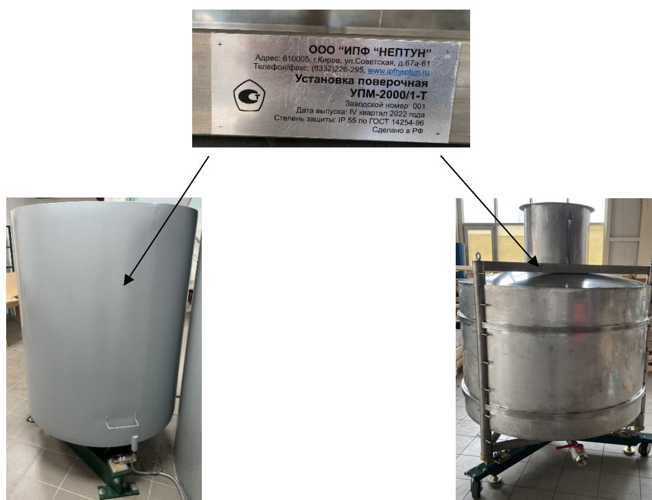
Рисунок 3 – Место нанесения знака утверждения типа и заводского номера
