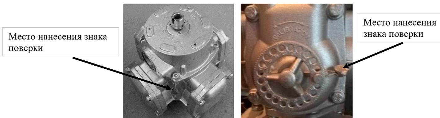
Рисунок 4 – Схемы пломбирования счётчика жидкости объёмного типа RSJ.
