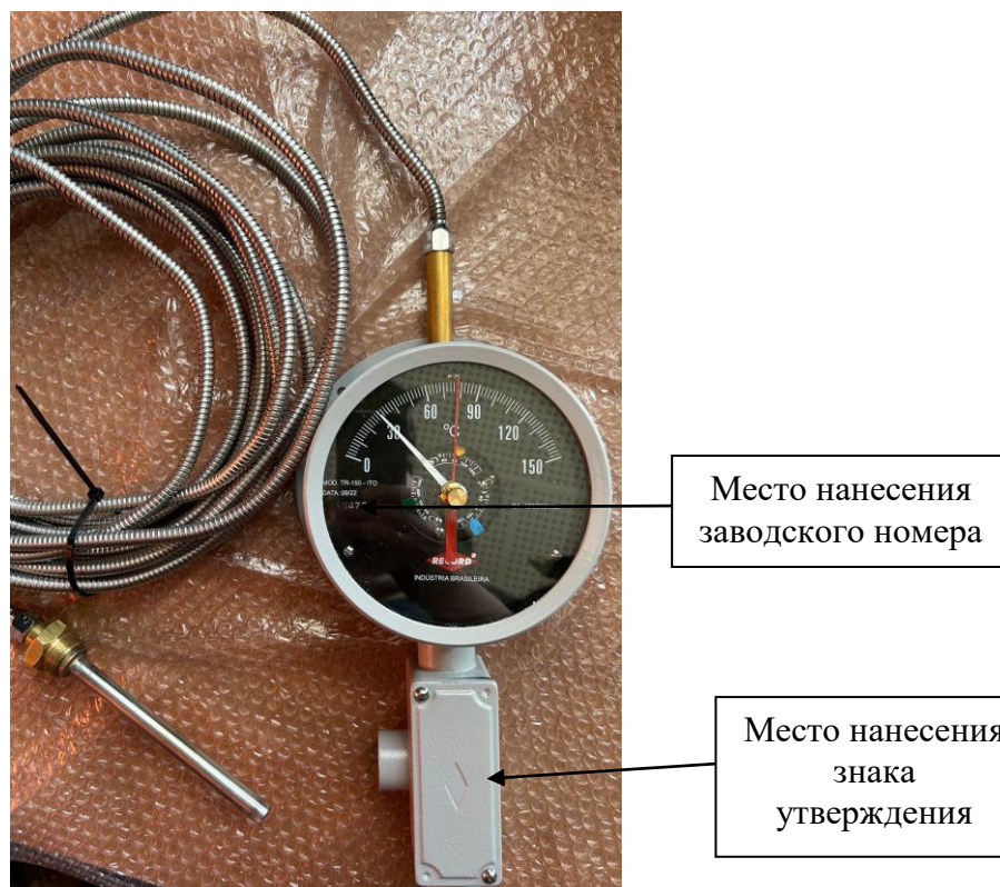
Рисунок 3 – Общий вид термометров модификации TR-150-ИТО и TR 150-ИТЕ с резьбовым соединением М3/4 с указанием места нанесения знака утверждения типа, места нанесения заводского номера
