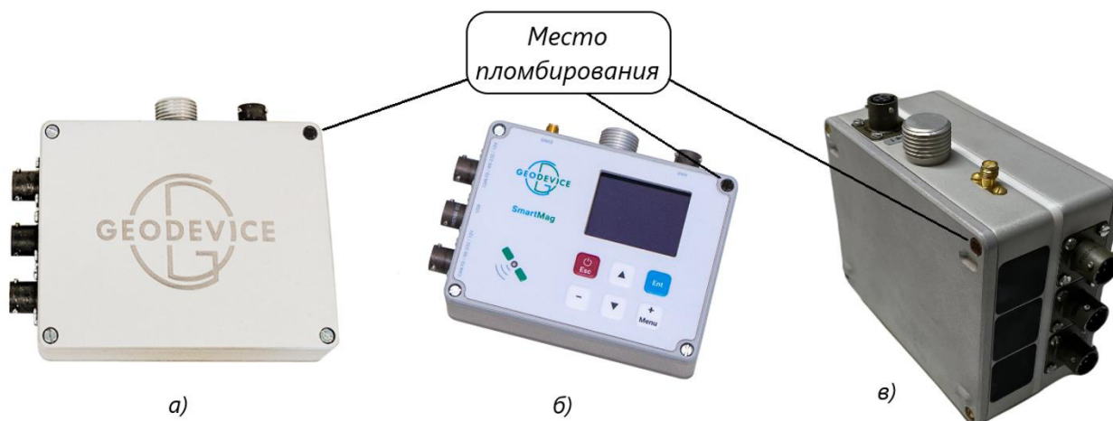
Рисунок 5 – Место установки пломбы а – блок электроники OVHmag; б – блок электроники SmartMag; в – блок электроники 2OVHmag
