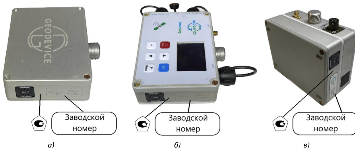
Рисунок 7 – Место нанесения заводского номера и знака утверждения типа а – блок электроники OVHmag; б – блок электроники SmartMag; в – блок электроники 2OVHmag
