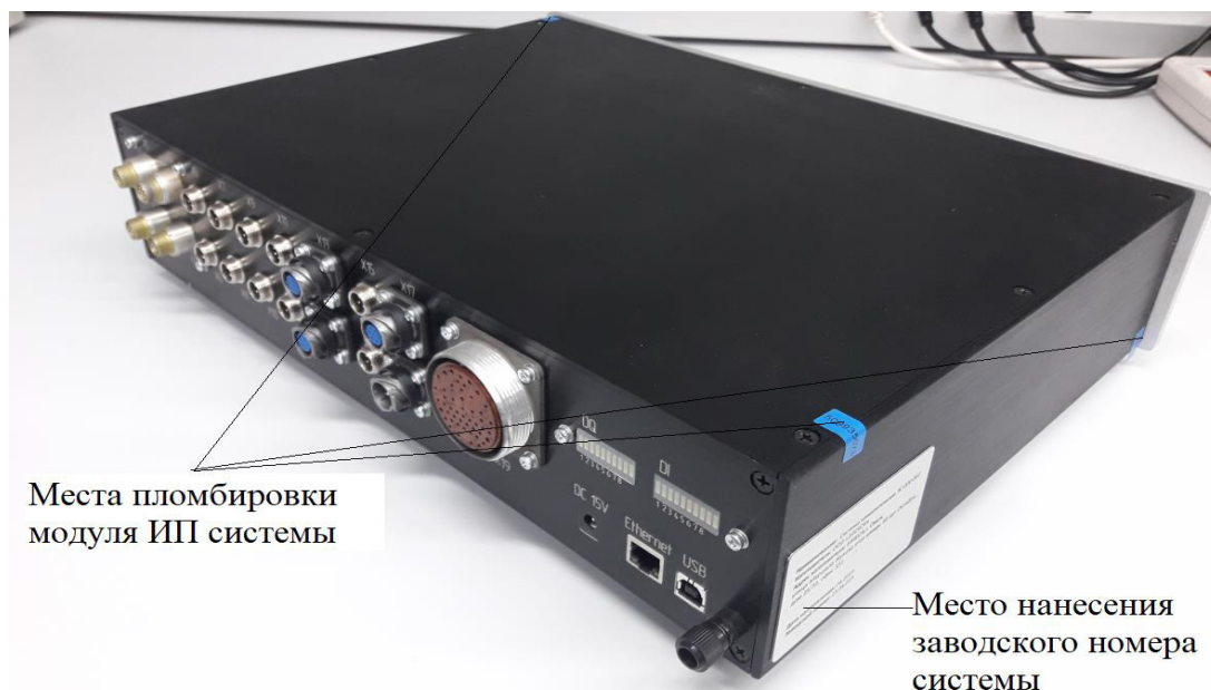
Рисунок 2 – Место нанесения заводского номера и пломб на модуль ИП системы
