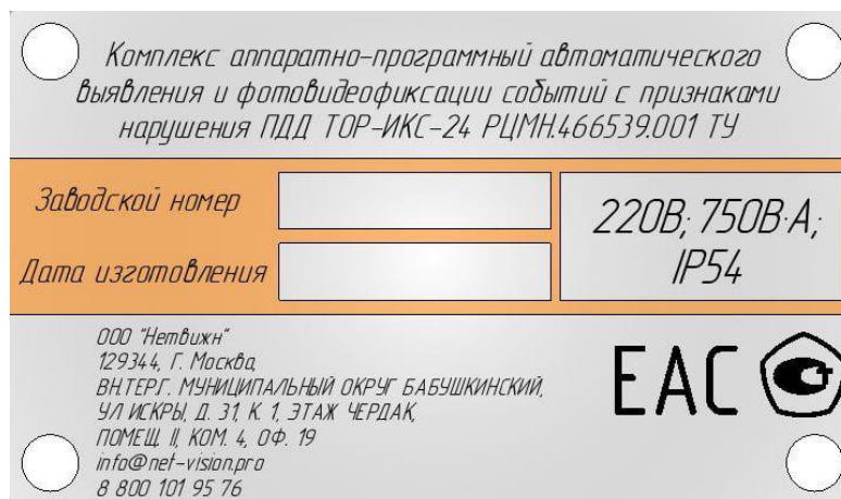
Рисунок 3 – Общий вид паспортной таблички
