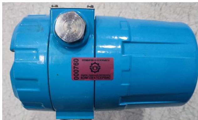
Рисунок 3 – Схема пломбирования датчиков от несанкционированного доступа
