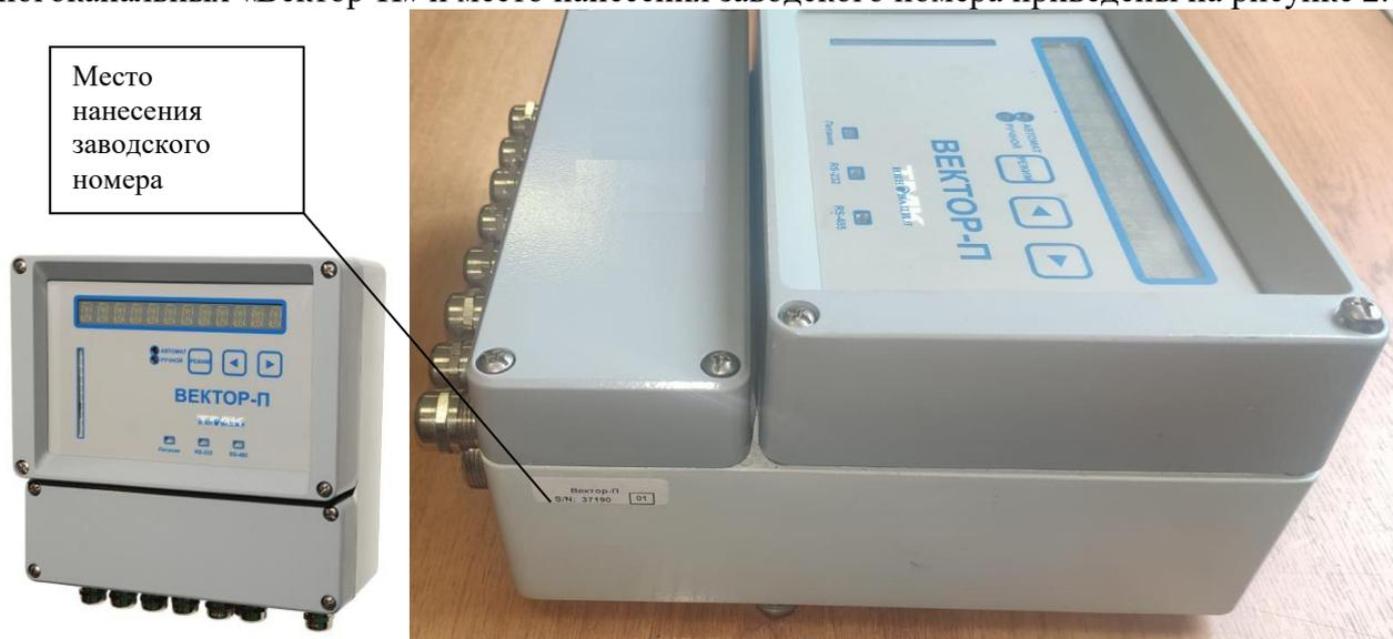
Рисунок 2 – Общий вид анализаторов параметров вибрации и механических величин многоканальных «Вектор-П» и место нанесения заводского номера
