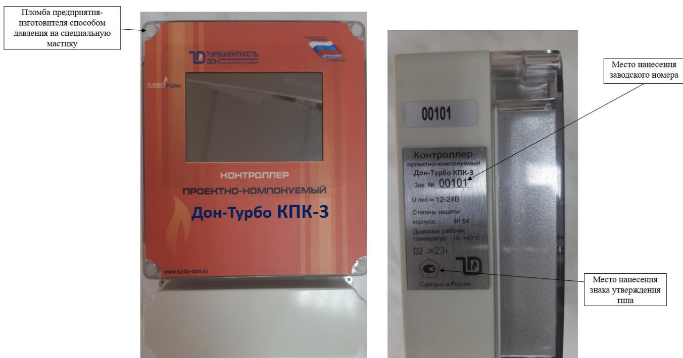
Рисунок 4 – Общий вид контроллеров в исполнении корпуса КПК-3 с указанием места нанесения заводского номера, места нанесения знака утверждения типа и мест пломбировки
