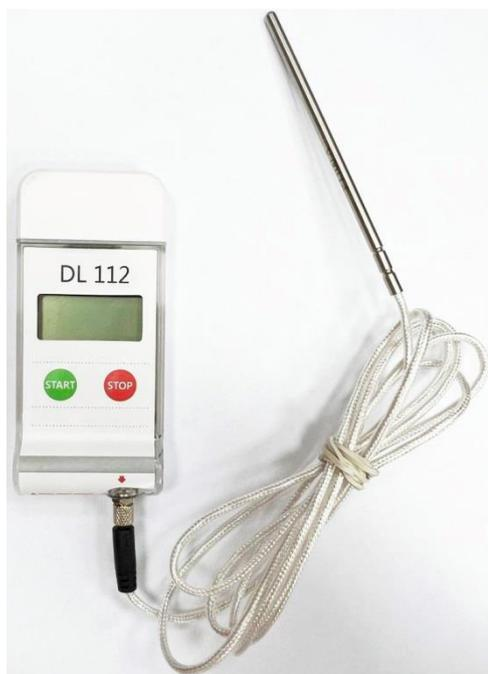
Рисунок 5 – Общий вид логгеров данных MerMax DL модели DL 112
