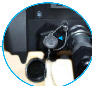
Рисунок 7 – Схема пломбировки от несанкционированного доступа весов с применением приборов весоизмерительных ТИТАН.
