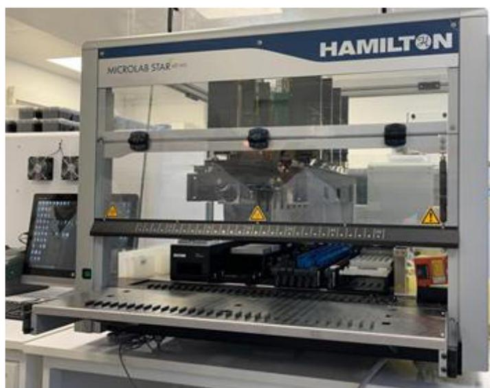
Рисунок 1 – Общий вид станций дозирующих автоматических с принадлежностями Microlab STARlet
