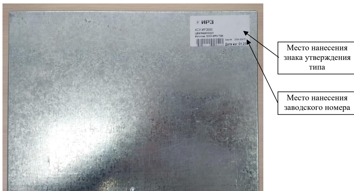
Рисунок 2 – Способ нанесения заводского номера контроллеров модификаций КСУ ИР3500 ЦВИЯ.468332.221, КОНТРОЛЛЕР СИРИУС-3А ЦВИЯ.468332.221-01, КОНТРОЛЛЕР СИРИУС-3А ЦВИЯ.468332.221-01/0001, КОНТРОЛЛЕР СИРИУС-3Л ЦВИЯ.468332.221-02
