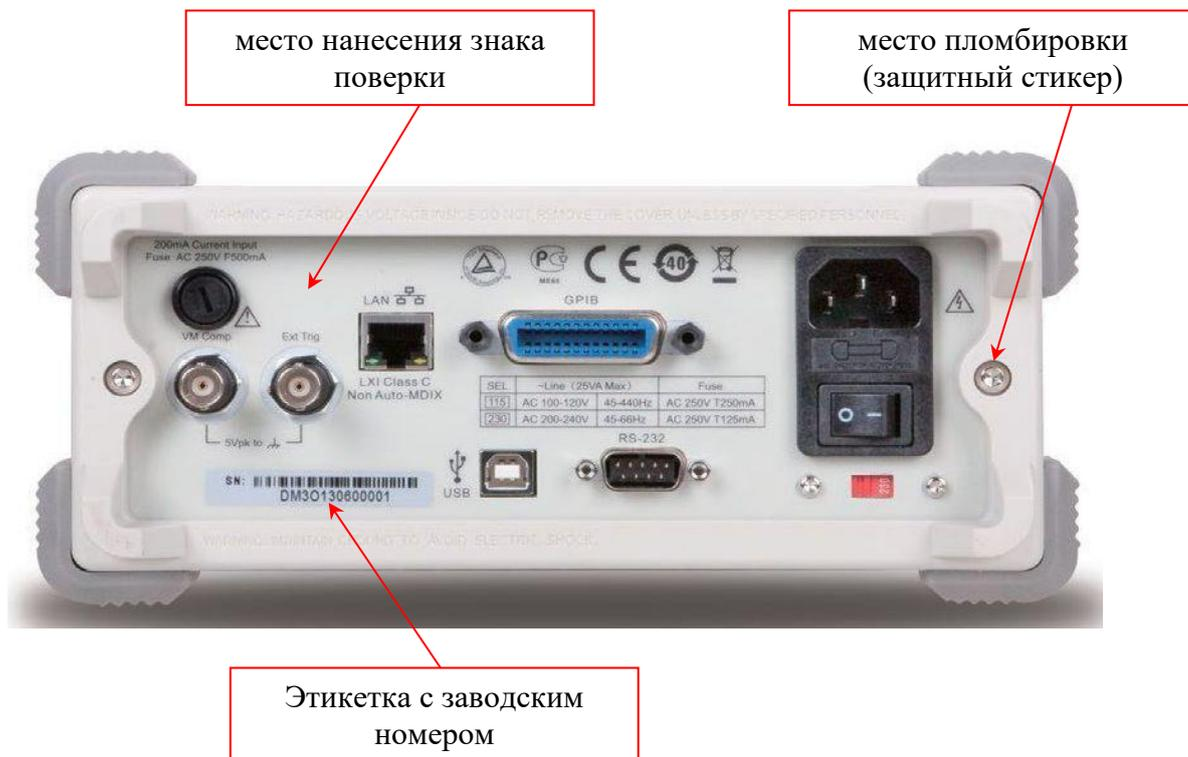
Рисунок 2 – Задняя панель DM3068
