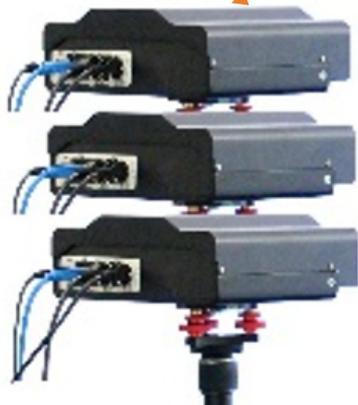
Рисунок 3 - Общий вид измерителей линейных перемещений АЕ модификаций АЕОНЕ3-ZZ N
