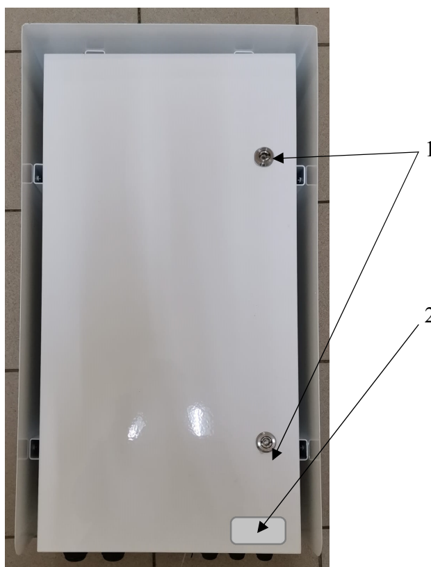
Рисунок 2 – Общий вид комплексов ИДЕМА с указанием мест пломбирования и мест нанесения заводского номера и знака утверждения типа:
