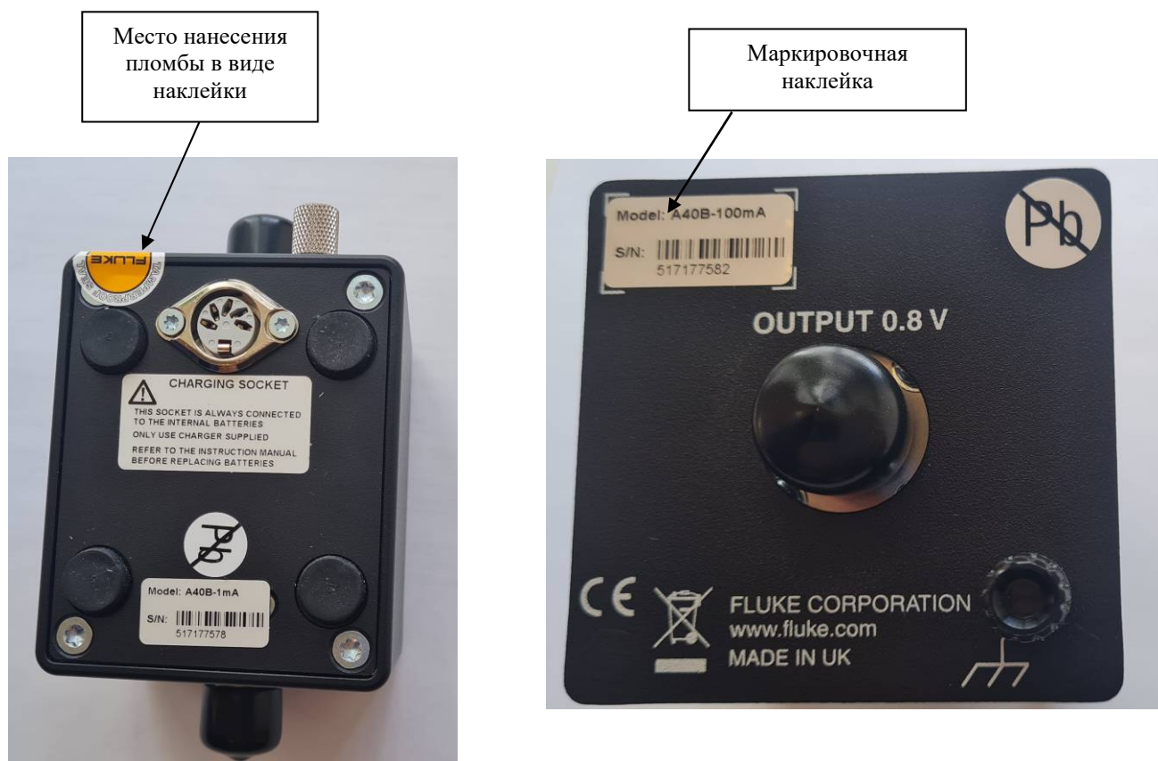
Рисунок 3 – Схема пломбировки от несанкционированного доступа, место нанесения маркировочной наклейки
