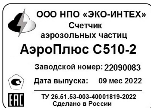
в) пример этикетки (место нанесения знака утверждения типа и заводского номера)
