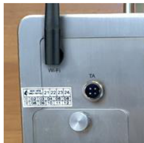
б) место пломбировки счётчиков портативного исполнения
