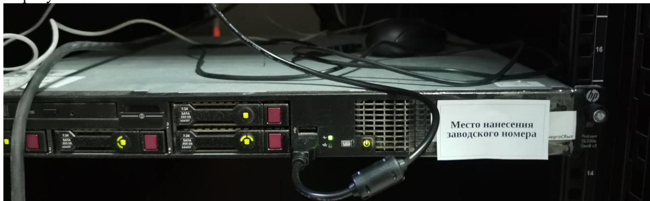
Рисунок 1 - Общий вид сервера ИВК с указанием места нанесения заводского номера.
