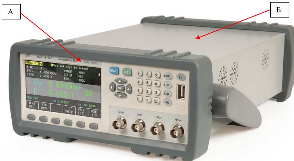
Рисунок 1 – Общий вид измерителей и место нанесения знака утверждения типа (А) и знака поверки (Б)
