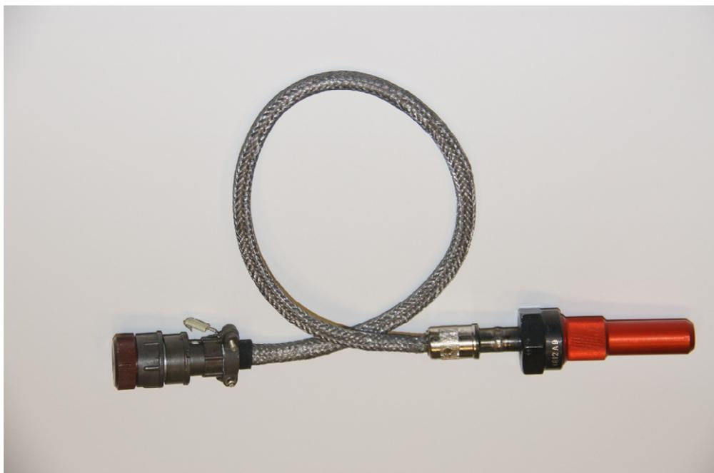
Рисунок 1 – Общий вид ТП в опломбированном виде с заглушкой на рабочей части и крышкой на разъёмном соединителем
