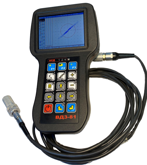
Рисунок 1 - Внешний вид дефектоскопов вихретоковых ВД 3-81
