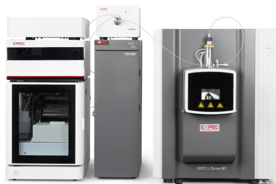
Рисунок 2 - Общий вид хромато-масс-спектрометров жидкостных с тройным квадруполем EXPEC L-Chrom MS (насос исполнение 2)
