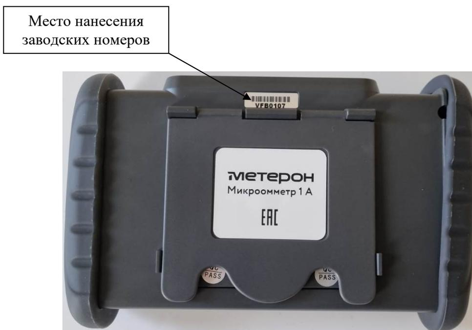
Рисунок 5 – Обозначение места нанесения заводских номеров на микрометрах Метерон МИО-1, Метерон МИО-1Р, Метерон МИО-10
