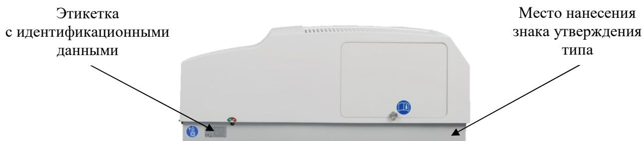
Рисунок 2 - Задняя панель спектрофотометров SPECORD 50 PLUS, SPECORD 200 PLUS и SPECORD 210 PLUS с указанием мест нанесения идентификационных данных, включая дату изготовления, и знака утверждения типа
