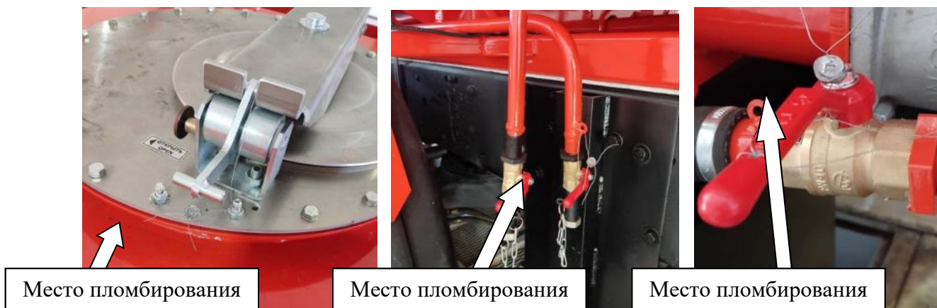
Рисунок 5 – Запорный механизм крышки заливной горловины, кран сливной для слива из отстойника и кран подвода топлива в отсек узла выдачи топлива
